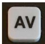
Pendant une séquence de stimulation, la touche AV vous permet de commuter entre le signal de stimulation dupliqué sur le dos et le signal d'horloge réduit.
