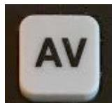
Die **AV-Taste** ermöglicht während einer Stimulationssequenz, zwischen dem auf der Rückseite dupliziertem Stimulationssignal und dem reduzierten Taktsignal hin- und herzuwechseln.
