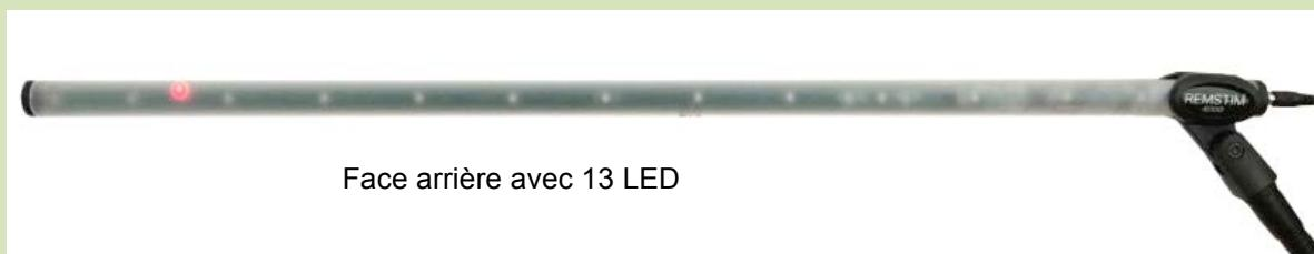
Par conséquent, le tube de stimulation doit être tourné de 180 degrés autour de l'axe du client pour aligner les 59 LED devant lui, selon sa position de la main droite ou gauche.
