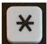
La touche étoile est la 2ème touche la plus importante et contrôle les fonctions de mise au point Focus 1 et Focus 2. Les deux fonctions de mise au point se terminent automatiquement au bout de 30 secondes si elles n'ont pas été relâchées précédemment en appuyant sur la touche rouge, c'est-à-dire au début d'une séquence de stimulation, ou si elles ont été interrompues activement.
